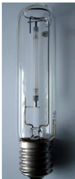
Rys. 1. Lampa sodowa wysokoprężna. Jarznik lampy wykonany z polikrystalicznego tlenku aluminium
