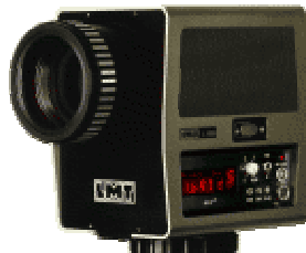
Rys. 3. Wygląd miernika luminancji z wbudowanym układem optycznym
