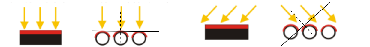
Rys. 4 Przy zmianie kąta padania promieniowania w kolektorach rurowych istnieje dalej powierzchnia prostopadła do kierunku padania promieniowania
